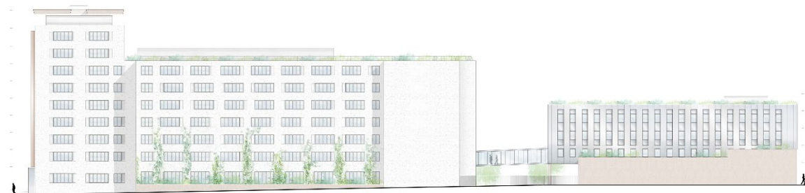
Remplacement des parois fusibles par des fenêtres
